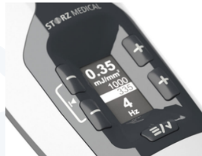
Applicateur avec afficheur et éléments de commande intégrés
